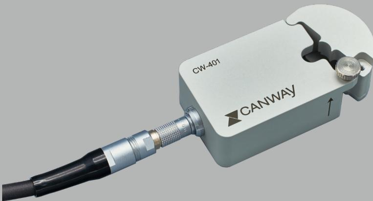
CW-401 MkII ist eine hochpräzise Stromzange für die kontaktlose Strommessung in den Messbereichen von  $\pm 10$  A bis zu  $\pm 1000$  A. Durch die hochwertige Verarbeitung und die geringe Größe ist die Zange besonders für den Einsatz an rauen und schwer zugänglichen Stellen geeignet, z. B. im Motorraum.
