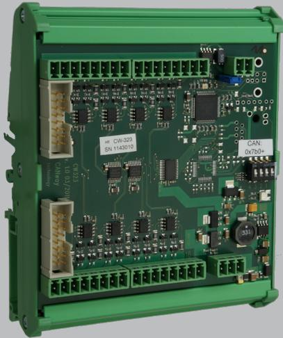
Mit CW-323 erweitert sich die CW-300er-Serie für Prüfstandstechnik um ein Modul zur Ausgabe von 16 analogen Spannungen. Diese Spannungen können bei der hohen Auflösung von 12 Bit frei zwischen 0 und 5 VDC gewählt werden. Angesteuert werden die Spannungsausgänge über den CAN-Bus. Alle 16 Spannungen können bei Bedarf synchron geschaltet werden.
