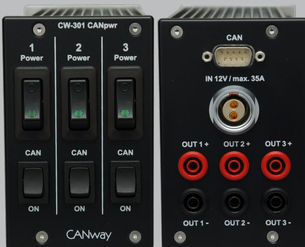
Das Modul CW-301 ermöglicht das Schalten von Leistungsrelais über CAN-Botschaften und manuelle Schalter. Somit kann z. B. die Spannungsversorgung für mobile Messtechnikanlagen durch ein bestimmtes CAN-Signal (z. B. KL15) geschaltet werden oder Messtechnikbatterien in definierten Fahrzeugzuständen geladen werden.
