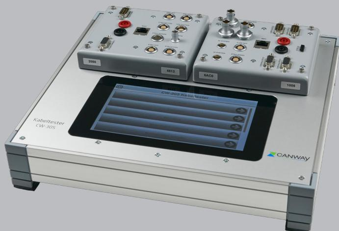
Das CW-305 MkII ist ein universeller Kabeltester zur gezielten Prüfung auf Durchgang, Unterbrechung, Kurzschluss, flüchtige Fehler und Leitungswiderstand. Insgesamt verfügt das Gerät über 240 universell nutzbare Signalleitungen. Die zu testenden Kabel werden über Aufsteckmodule mit den Signalleitungen bzw. dem Basisgerät verbunden. Neben der Verwendung von Standard-Aufsteckmodulen (D-Sub-Steckertypen) besteht die Möglichkeit individueller Steckerkonfigurationen nach Kundenanforderung.
