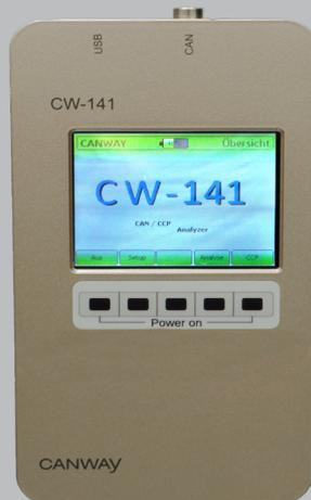
Das CW-141 ermöglicht die Untersuchung und Analyse von CAN-Netzwerken. Konzipiert als tragbares Handgerät in einem robusten Aluminium-Gehäuse ist es besonders geeignet für den mobilen Einsatz.
