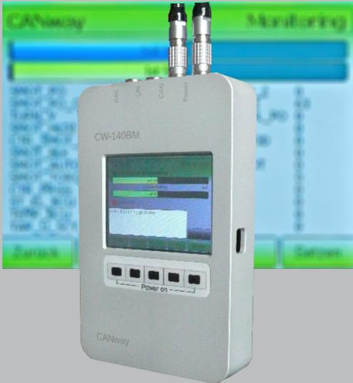
Das CW-140 „Interface für CAN und LIN“ ist ein Bus-Interface für verschiedene, automotiv Bussysteme. In der Basisausführung stehen zwei CAN-Busse und zwei LIN-Busse sowie zwei Kanäle mit Digital-Analog-Wandler zur Verfügung.
